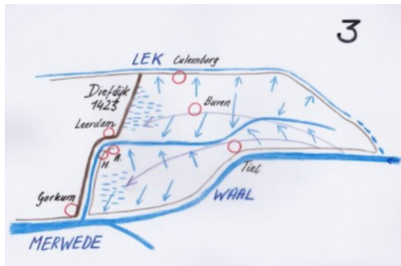
Figuur 3, De Diefdijk (1400-1700) : De Diefdijk-Noorderlingedijk is een solide dwarsschot. De Nederrijn verzand; afwatering richting Lek is aantrekkelijk. Molentechnologie maakt het 'opvoeren' van water en 'boezems' mogelijk. Overstromingsdreiging komt van de Waal (paarse pijlen).
