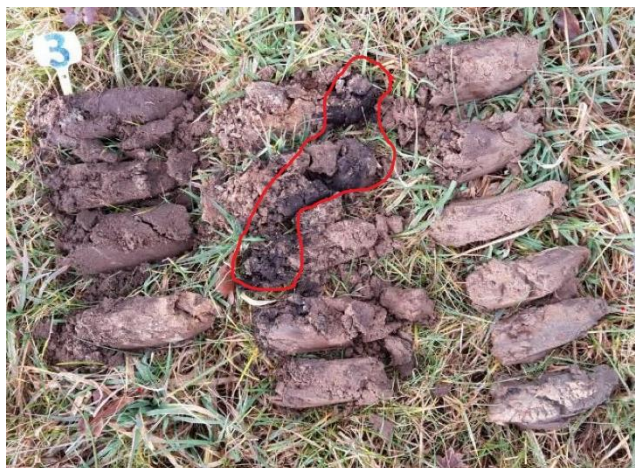
Figuur 2: Boring 2 begraven (opgehoogde) voormalige broekerdgrond. Hier is ongeveer 35 cm grond opgebracht. Met rood oude maaiveld aangegeven.
