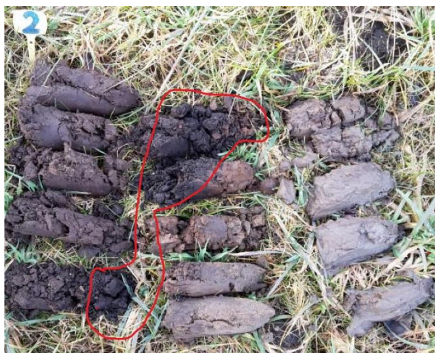
Figuur 2: Boring 2 begraven (opgehoogde) voormalige broekerdgrond. Hier is ongeveer 35 cm grond opgebracht. Met rood oude maaiveld aangegeven.
