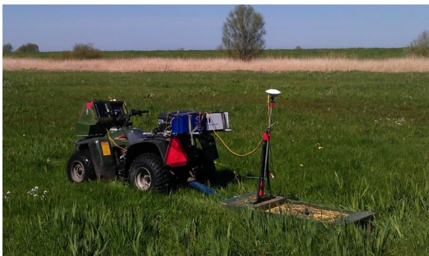
Figuur 12: quad met daaraan gemonteerd de gammaspectrometer (achter op de bagagedrager van de quad) en de grondradar (antenne achter de quad).
