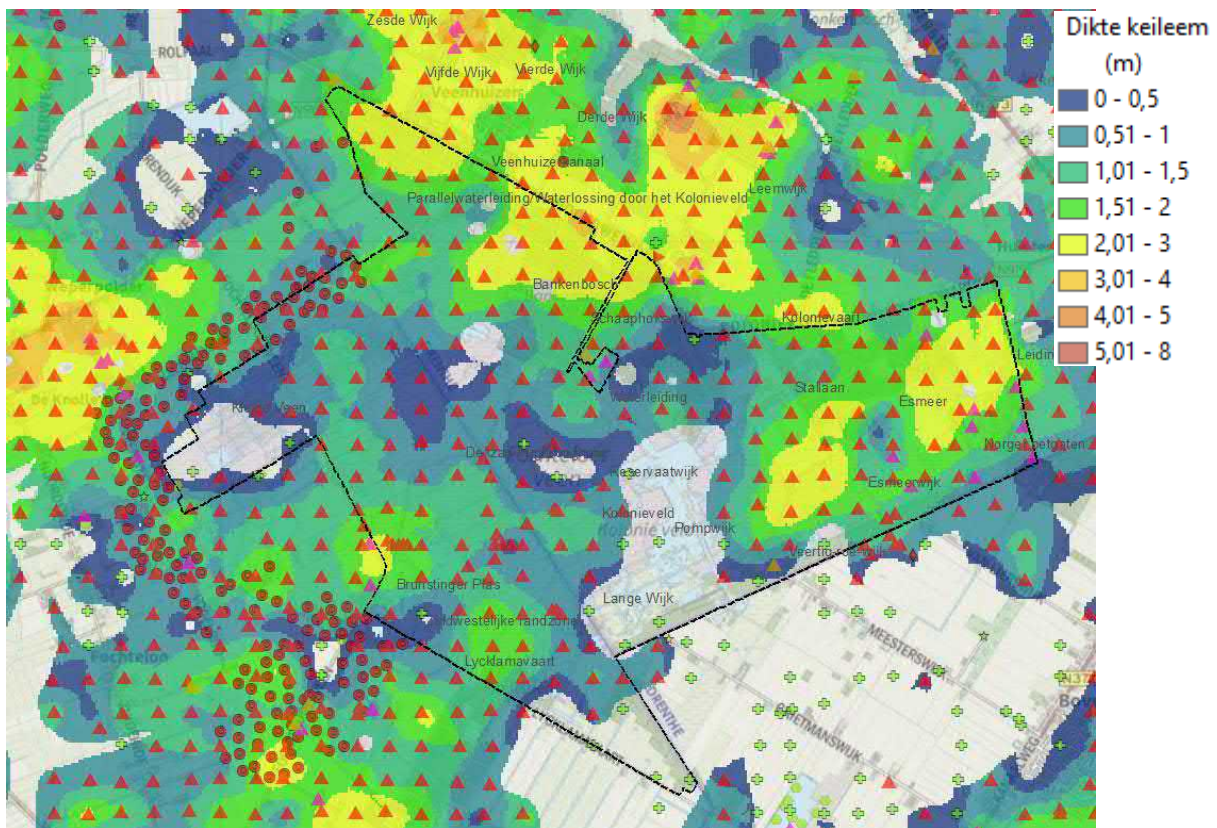
Figuur 3-3 Keuleemdikte (TNO 2011). Rode bolletjes en driehoeken: keuleem in boorprofiel aangetoond. Groene plusjes: geen keuleem aangetroffen in boorprofiel
