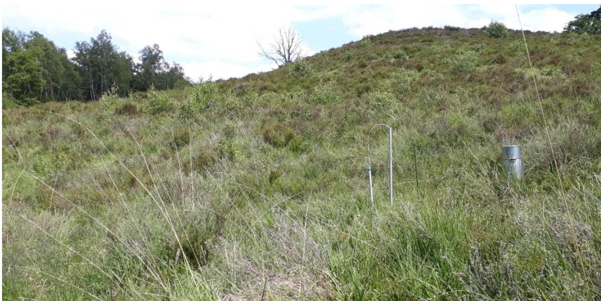
Figuur 3.1. Foto van een van de hellingveentjes met hierin twee ceramische cups (grijze PVC buisjes) en een peilbuis van de Provincie Limburg (foto G. van Dijk)
