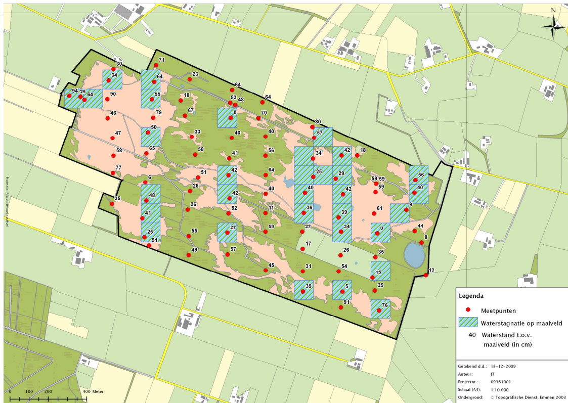
Figuur 15: Waterstanden ten opzichte van maaiveld op 27 november 2009 zoals gemeten in boorgaten. Tevens is aangegeven of zich in de directe nabijheid van de boorgaten plassen op het maaiveld bevinden. Voor verdere toelichting zie tekst.
