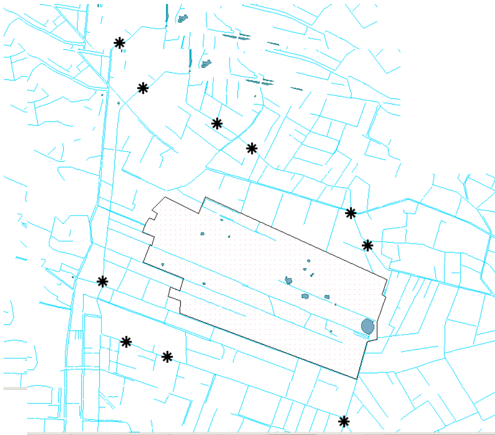
Figuur 12: Waterlopen in en om het Boetelerveld. Veel van de greppels in het Boetelerveld ontbreken. Met * zijn de locaties van stuwen en vaste overlatten weergegeven.
