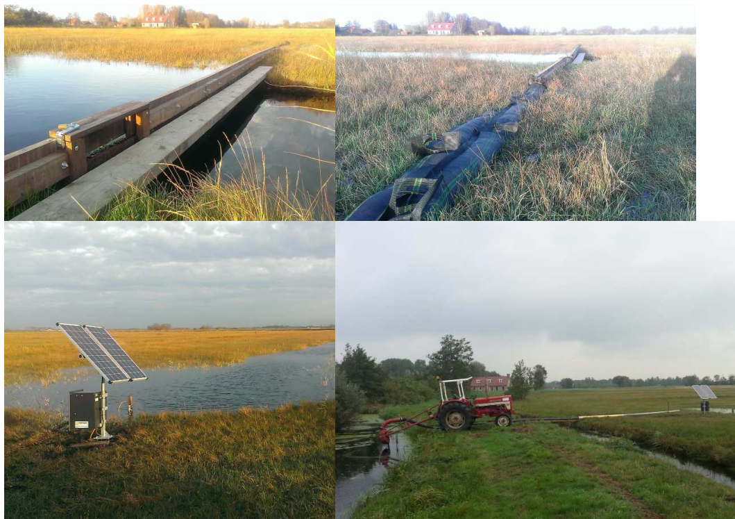
Figuur 5.2. Impressie van onderdelen van de inundatie-installatie. Van linksboven naar rechtsonder: de houten damwand met spindelschuifje, grontubes om voldoende kerende hoogte naar het gebied buiten de inundatieproefvlakken te realiseren, zonnepaneel met dompelpomp, bijzetten van extra pompcapaciteit. Op deze laatste foto is ook te zien uit welke watergang (direct zuid langs de Meije) het inundatiewater werd onttrokken.
