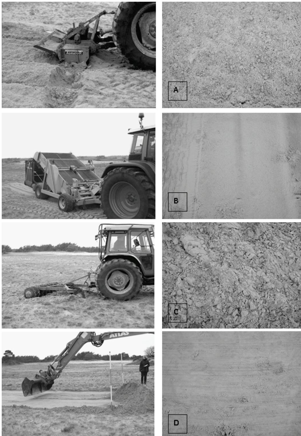
Figuur 8.1. Gebruikte groundbewerkingsmethode en oppervlak na bewerking: (A) landbouwfrees; (B) stuifzandreiniger; (C) schijveneg; (D) graafmachine.
