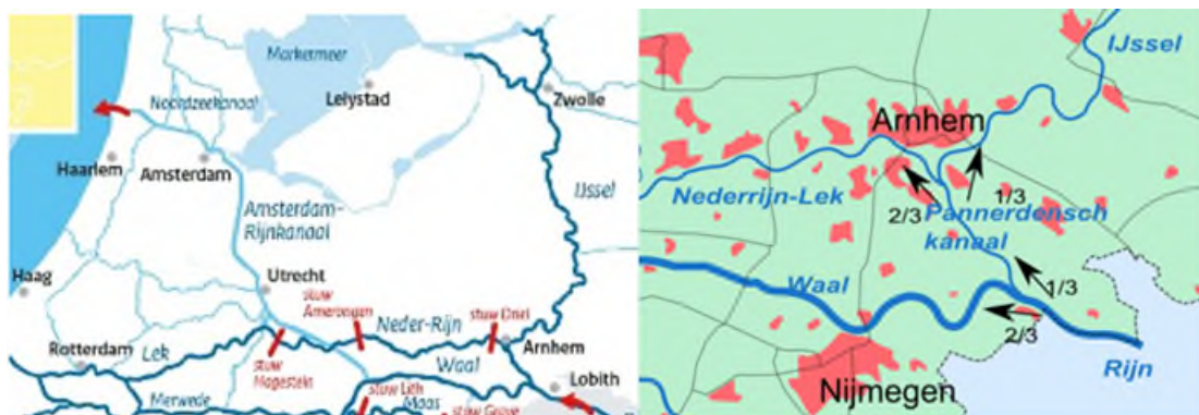
Figuur 5.8 Links stuwen in het systeem, rechts waterverdeling Waal, Nederrijn en IJssel
