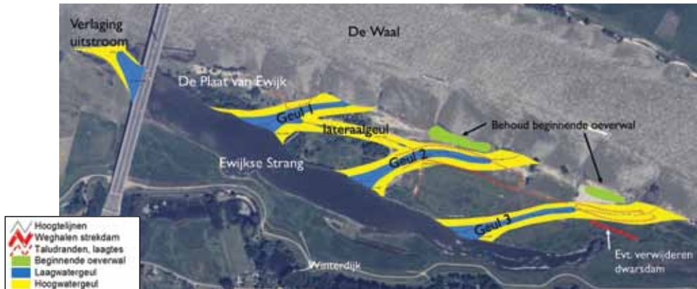
Figuur 133. Het inrichtingsplan van de Ewijkse Plaats zoals nu in uitvoering om de hydraulische weerstand van ontwikkeld oobos volgens het concept van Cyclische Verjonging terug te zetten. Op de foto's is zichtbaar hoe de Ewijkse Plaats zich ontwikkelde na afgraving in 1991 en hoe het terrein er in 2011 tijdens uitvoering van de werkzaamheden uitzag (foto's Maaswerken en Bart Peters).
