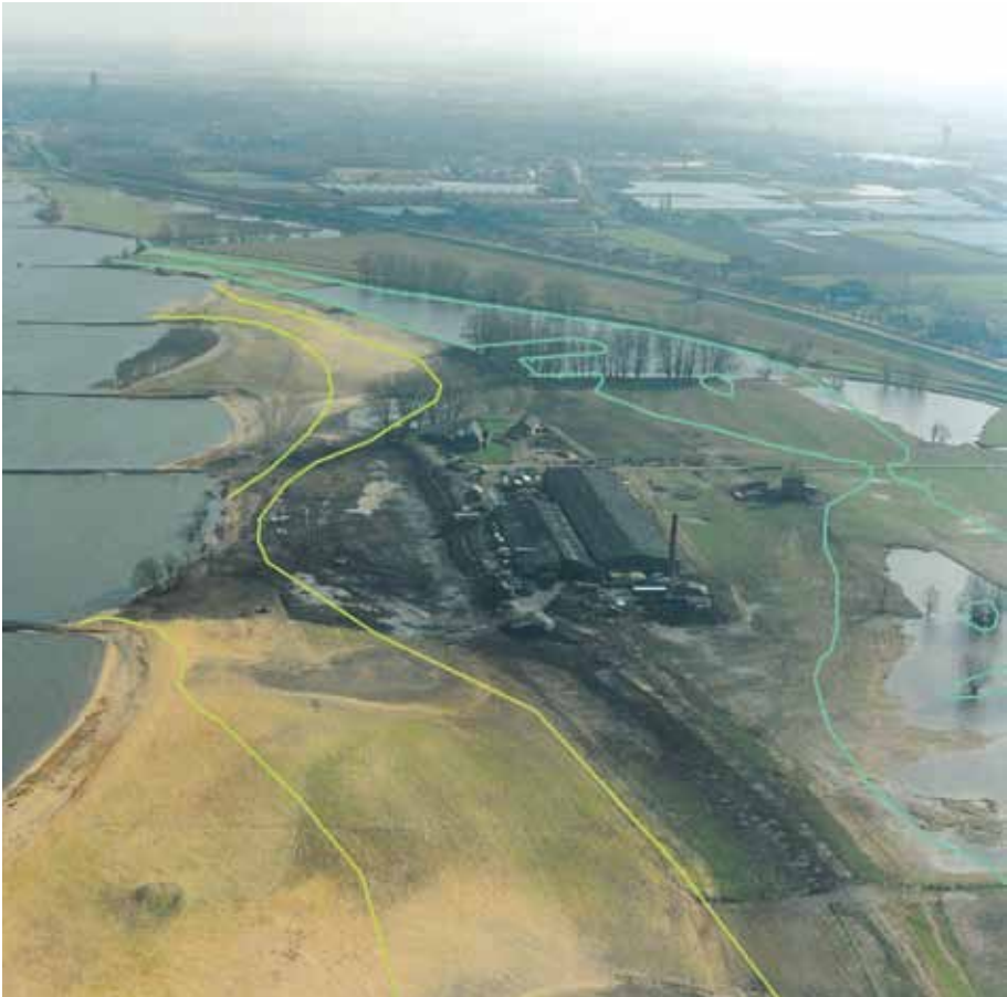
Figuur 100. De uiterwaard van Gameren in 1994 met de contouren van de toekomstige nevengeulen die in 1996-1999 werden aangelegd om klei te winnen voor de versterking van de winterdijken in de regio (foto Rijkswaterstaat).
