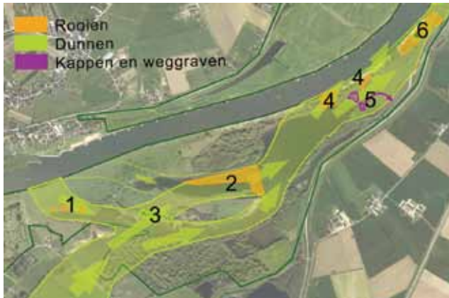
Figuur 134. Een voorbeeld van een Stroomlijnontwerp voor de Duursche Waarden, waarbij de meest opstuwende stukken oobos in de stroombanen worden verwijderd, maar waarbij het karakter van een bebost geulenlandschap behouden blijft (Voorlopig ontwerp Staatsbosbeheer).
