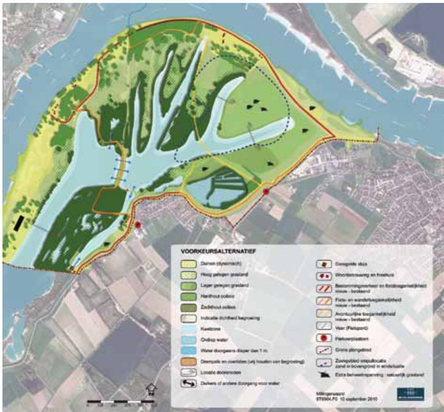
Figuur 121. Inrichtingsplan voor de Millingerwaard, met een zoekgebied voor een dekgrondberg voor zandwinning met opvulling (omputten). Aandachtspunten voor de kwaliteit zijn dat de geplande kleiberging niet de rivierkwelstroom vanuit de Waal naar de hoogwatergeul gaat onderbreken en dat er geen kleibodems (maar zand) in de nieuwe geulen achterblijven (bron DLG / Royal Haskoning).
