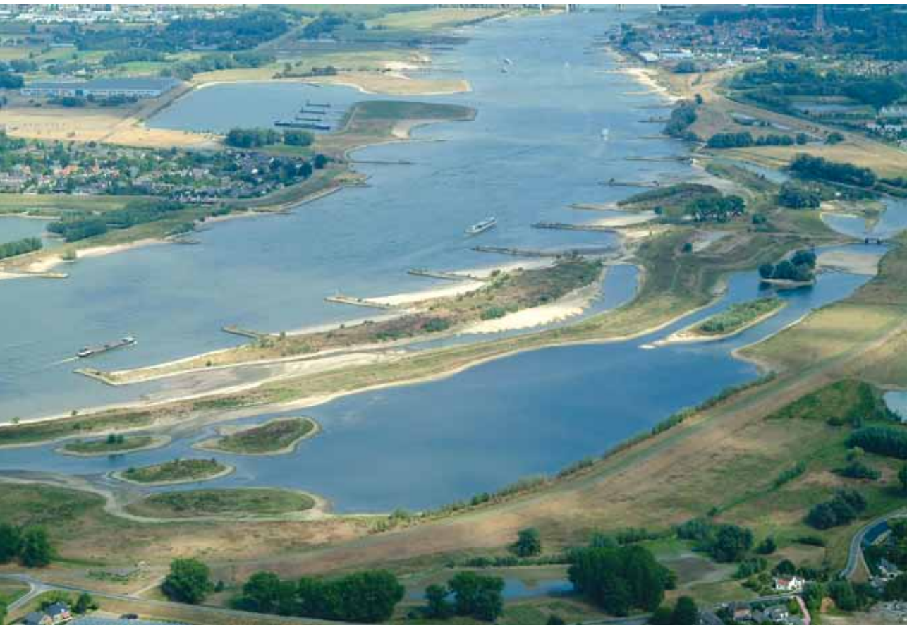
Figuur 101. De uiterwaard van Gameren in 2003, circa 5 jaar na de aanleg van de nevengeulen (foto Bert Boekhoven).
