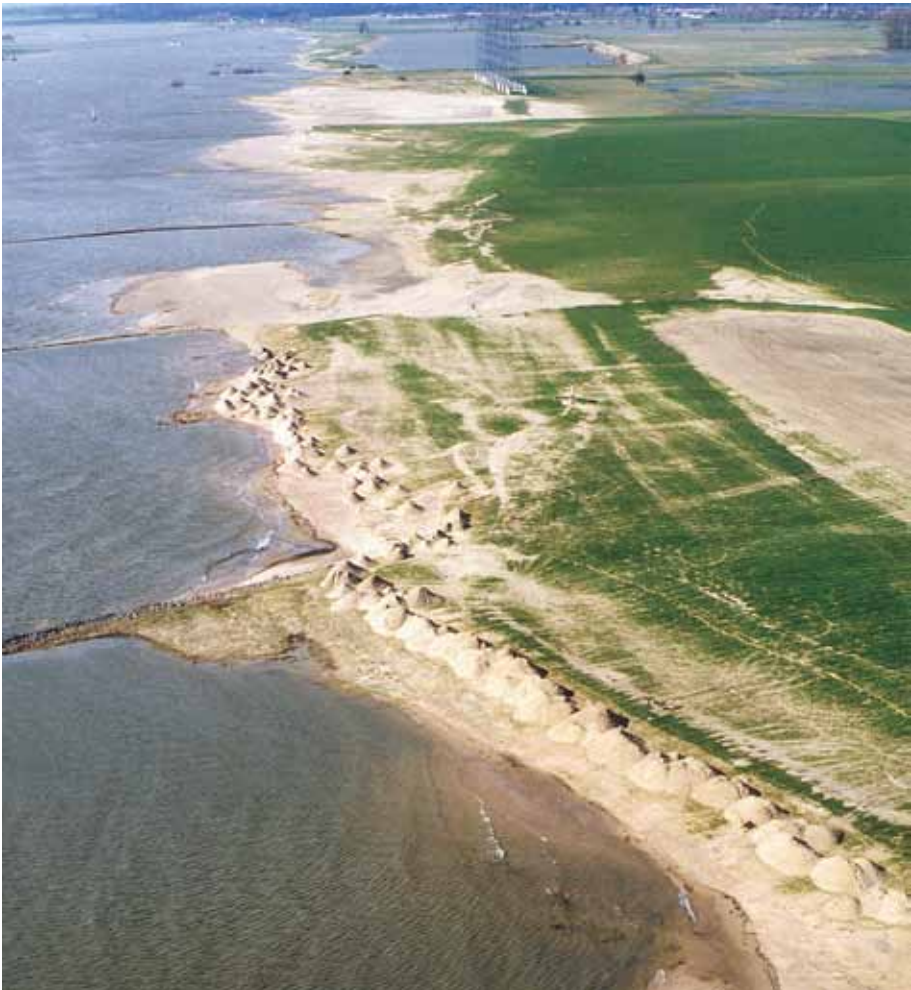
Figuur 65. Grotere zandafzettingen op oeverwallen worden op agrarisch gronden doorgaans bijeen geschoven en verkocht. Hier liggen bijeen gereden hopen zand in de Oosterhoutse Waard na het hoogwater van december 1993 en klaar om afgevoerd te worden. In de nieuwe natuurgebieden kon dit zand blijven liggen en nieuwe oeverwallen vormen (foto Rijkswaterstaat).
