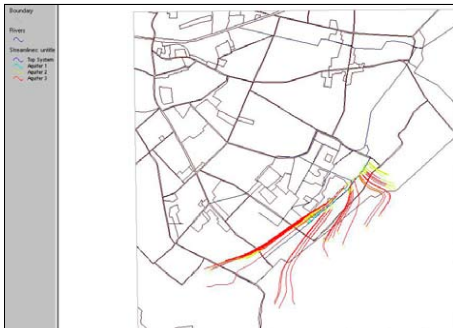
Fig. 4.4. Stroombanen van het kwelwater dat afkomstig is van het Reichswald en dat door de Nieuwe Leigraaf wordt opgevangen en afgevoerd in de huidige situatie. Dit water bereikt de rest van De Bruuk niet.
